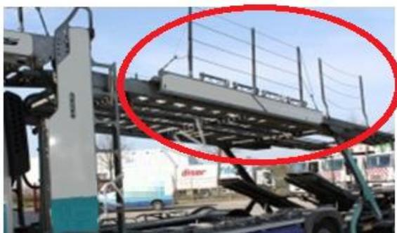
cavo anticaduta in acciaio ricoperto in PVC per mezzi trasporto veicoli fornito in bobine da mt. 200 / 500 ns.ref. AR-10900
